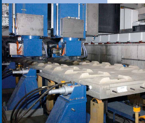
Úprava modulu vozovky pod trasou vysokorychlostních vlaků ICE: přesně fixovaný beton o váze 9 tun.
